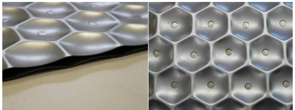
Abb.: Leichtbauelement/Halbzeug aus zwei gefügten strukturierten Blechen (links) und die eingebrachten wabenförmigen Makro-Versteifungselemente (rechts)
